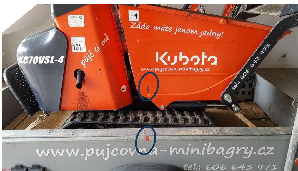
Obr. č. 2 – vyvážení vozíku – značky na dumperu a vozíku musí lícovat proti sobě:
